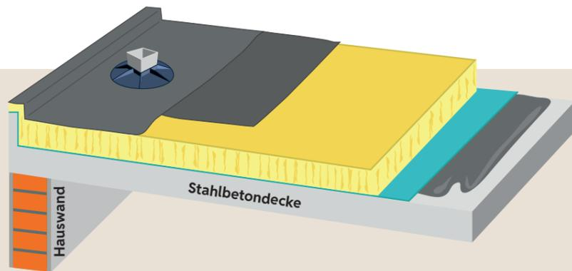
Der Aufbau eines Balkons mit Verwendung der Druckausgleichsplatte, um die punktuelle Druckbelastung durch die Terrasse zu verteilen.
