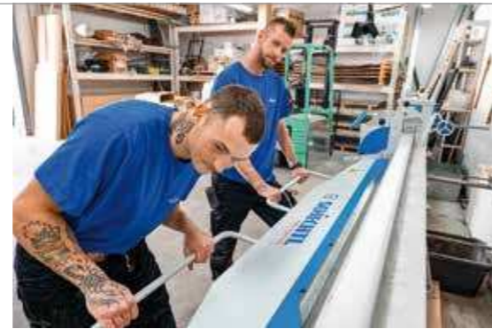
In der firmeneigenen Klempnerwerkstatt wird das Material für die Metalleindeckung verarbeitet.
